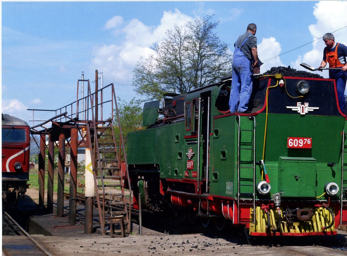
▼ Локомотивы 77 009 и 76 609 готовы покинуть депо Septemvri. Танк-паровоз вмещает почти 4 т угля, достаточно, чтобы хорошо поработать лопатой.
